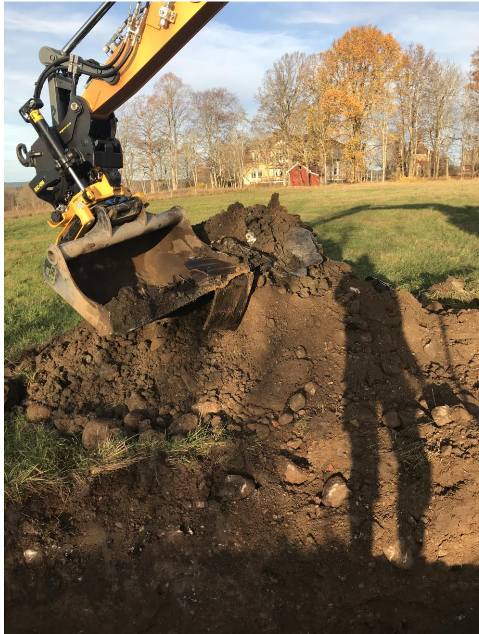
Figur 6 I provgrop 20SC02 noterades teknisk förorening i form av trä, plast och metallrester.
