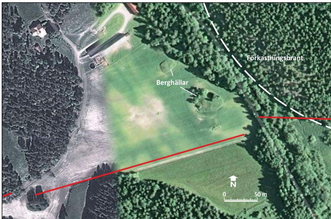
Figur 11. Satellitbild som visar den centrala delen av profilen längs vilken det utförts refraktionsseismik, samt de berghällar som förekommer i åkern norr om profilen och förkastningsbranten längs Garpån. Notera mönstret i fältet väster om berghällarna vilket indikerar ett ringa jordtäckte ( https://maps.google.se/ , 2014-02-03).
