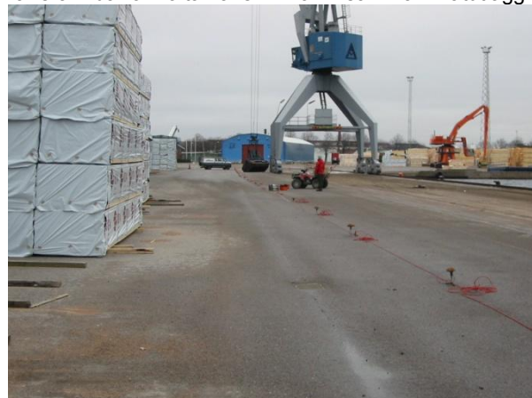
Figur 3. Mätutlägg med geofoner och geofonkabe på asfalt.
