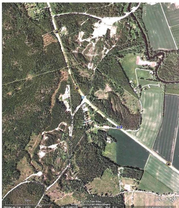
Figur 23. Mogetorpsmagasinet. Mycket grusbrytning, men inget under grundvattenytan.
